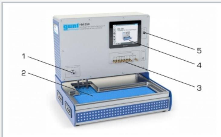
1 raccord d'eau pour accessoires, 2 réservoir de stockage avec insert en mousse, 3 raccords de mesure de pression, 4 écran tactile, 5 raccordement USB
