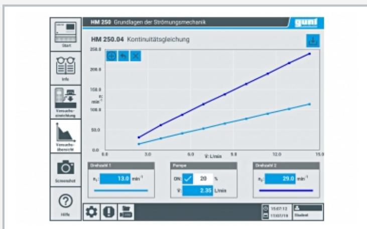
Interface utilisateur intuitive sur l'écran tactile du HM 250: affichage graphique des valeurs de mesure, vitesses de rotation des deux roues à ailettes dans différentes surfaces de section de la section de tuyau
