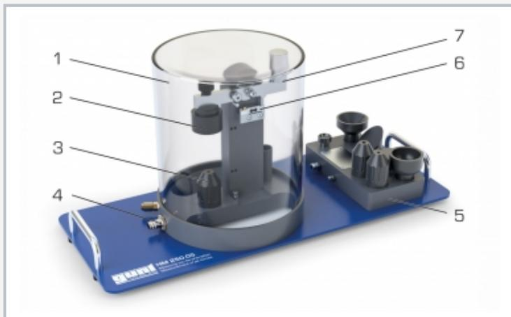
1 pare-éclaboussure transparent, 2 déflecteur, 3 buse, 4 alimentation en eau, 5 tablette de rangement pour buses et déflecteurs, 6 poutre en flexion, 7 levier
